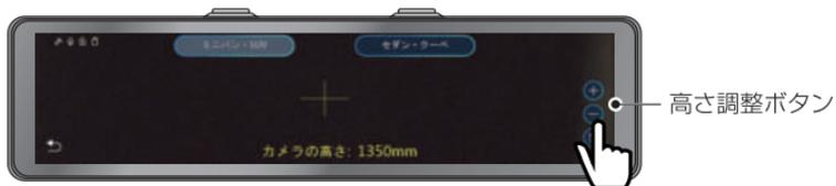
4. リヤカメラを動かして、BSM補正用十字マークと液晶画面に表示されている黄色の十字マークの中心を重ねるようにして合わせます。
