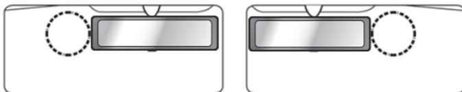
2. フロントカメラの粘着シートを剥がして、フロントガラスに貼り付けます。
