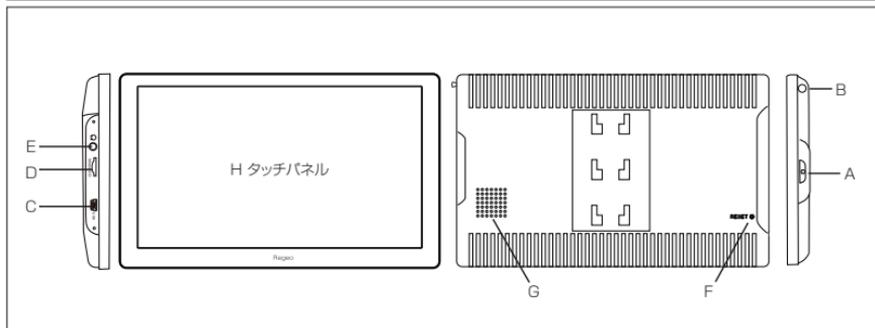
**A 電源ボタン** 電源が切れた状態でこのボタンを長く押すと電源が入ります。再度長く押すと電源が切れます。
