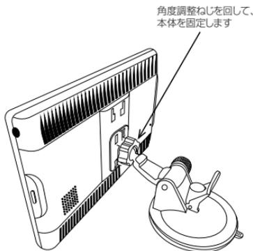
角度調整ねじを回して、本体を固定します
