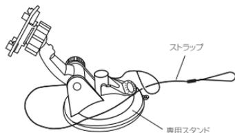
③フックを車両のデフロスタ(フロント部分のエアコン送風口)へ取り付けろ
