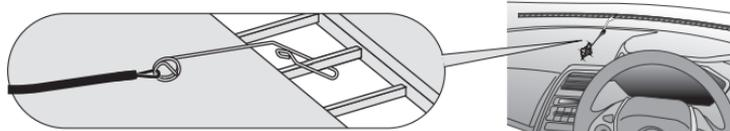
④スタンドの位置を固定して、余ったストラップをコードリールに巻きつけて緩まないように長さを調整する
