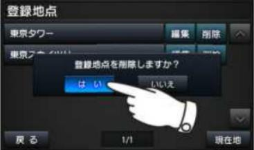
リストから削除したい地点の「削除」ボタンをタッチして、「はい」をタッチすると選択した地点情報が削除されます。
