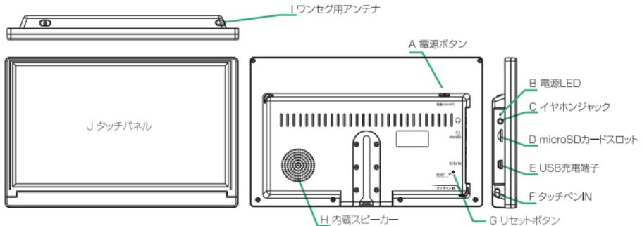
**A 電源ボタン** 電源が切れた状態でこのボタンを長く押すと電源が入ります。再度長く押すと電源が切れます。
