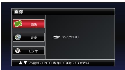
マイクロSDカードを挿し、リモコンのSOURCEボタンを押して、マイクロSDモードを選択します。カードにある画像、音楽、ビデオを再生できます。
