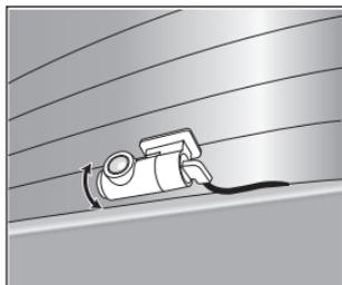
リヤウィンドウの上部に貼り付け、角度調整することで、最適の映像を録画できます。
