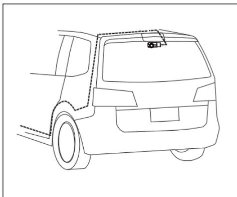
上図イラストでは、車内下側を配線していますが、車種によっては、リヤカメラケーブルの取り回しにより、車内上部(ルーフ、内張内等)を通す必要があります
