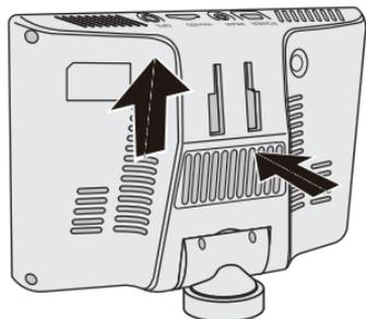
本機の背面にある凹部分とブラケットの凸部分を合せて、ブラケットを上方にスライドしながら固定します。
