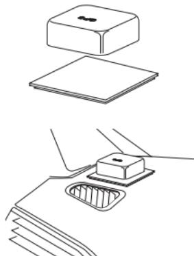
付属のGPSユニットとGPSユニット固定用鉄板プレートを取り付けます。
