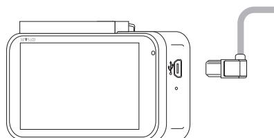
次に、車両のシガーソケットにシガーアダプターを接続します。
