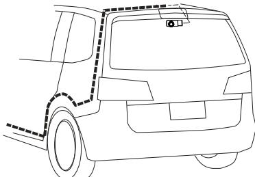
バックドアやトランクを開閉して、配線が挟まれていないかを確認してください。
