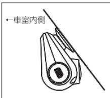
6. リアカメラ接続ケーブルをリアカメラ本体のポート（端子）に接続します。
