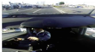
フロントおよびバック(リア)方向を上下2分割にして表示します。
