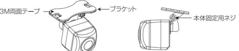
ケーブルとカメラ本体が干渉する場合、本体固定用ネジを外して
