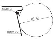
■5mm以上の突起部分が、直径100mmの球と接触しているが、 接触部分の曲率半径が2.5mm以上にである
