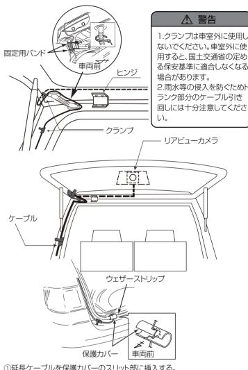
①延長ケーブルを保護カバーのスリット部に挿入する。 ②保護カバーをウェザーストリップに巻きつけるように取り付ける。
