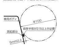
■ 5mm以内の突出部分が、直径100mmの球と接触しているが、 接触部分の角が丸処理されている
