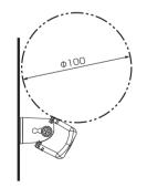
■ 取付用U型ブラケットが直径100mmの球と接触する
