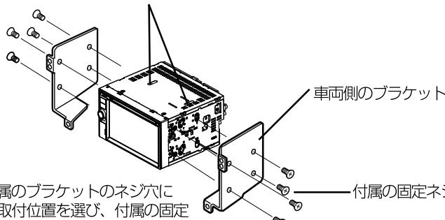
2. 車両に付属のブラケットのネジ穴に合わせて取付位置を選び、付属の固定ネジで取り付けます。
