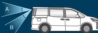
A:カメラモード映像表示角度 B:リバース連動で表示される映像表示角度
