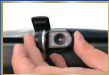
リアガラスにカメラを取り付け
