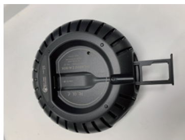
SIM カードスロットを抜き出します
