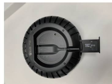
microSD カードを装着して カードスロットを閉じます
